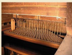
Vue arrière de la traction mécanique du Clavier d'Echo
